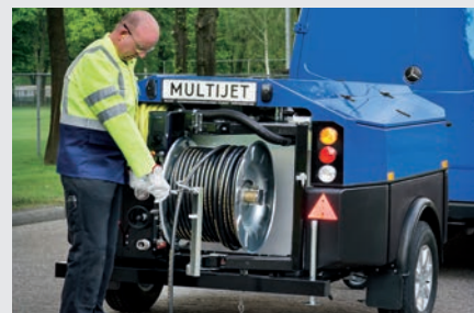
Hydraulische, 180° ausschwenkbare HD-Haspel
